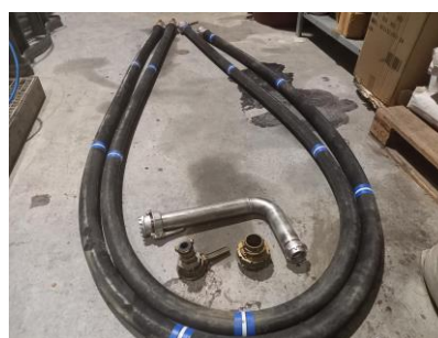
C-pentán lefejtéshez használt tömlők és csatlakozók
